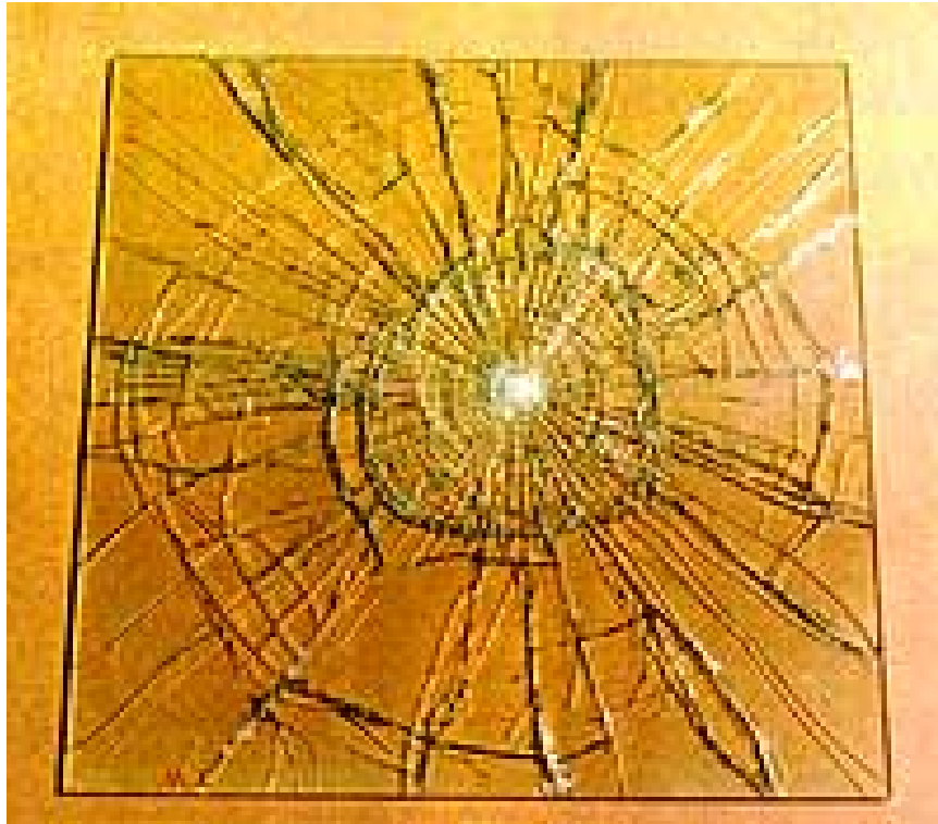
図 4.1: 実際の合わせガラスのひび割れ (日本総合研究所 エンジニアリング事業本部 [6])
