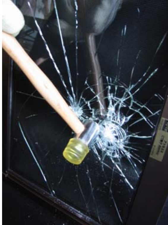
図 2.6: 亀裂の集中 (株式会社リプロス [12], 株式会社ガラスアシスト [13])
