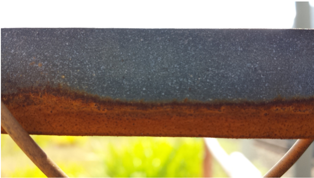
図 4.4: 実際に水が付着して進行した錆画像
