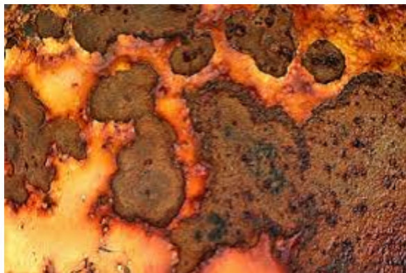
図 1.5: 凹凸の変化がある錆の実例
