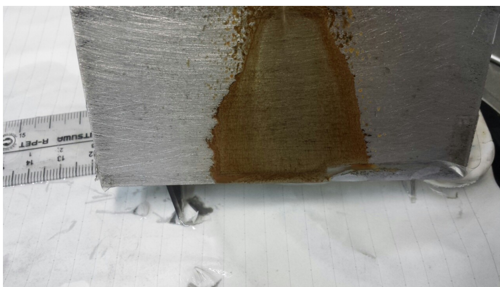
図 1.2: 鉄板に水を流してから 3 時間後の実験画像
