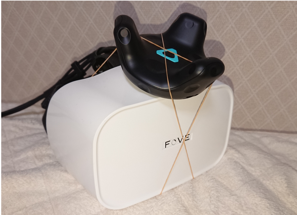
図 2.6 VIVE トラッカーを使用して FOVE の位置角度トラッキングを行うための機材
